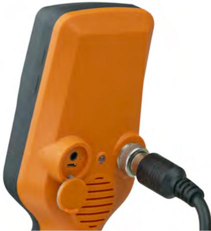
Nehmen Sie die Feuchtigkeits- und Staubabdeckungen für den Zugang zu den Buchsen ab. Setzen Sie diese wieder ein, um Schäden durch Schmutz oder Feuchtigkeit zu vermeiden.
