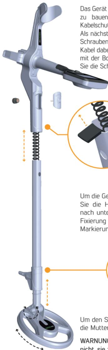
Das Gerät wird in 2 Teilen zerlegt geliefert. Um das Gerät zusammen zu bauen, entfernen Sie zuerst das kleine schwammartige Kabelschutzstück an dem mittleren Gestänge und entsorgen Sie es. Als nächstes wird das Gestänge so in einander gesteckt, dass das Schraubenloch mittig im Schlitz liegt. Achten Sie darauf, dass das Kabel dabei nicht beschädigt wird. Legen Sie dann das runde Stück mit der Bogenmarkierung nach oben in den Schlitz. Zuletzt ziehen Sie die Schraube zur Sicherung fest.
