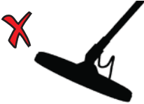
Falscher Winkel der Suchspule zum Boden
