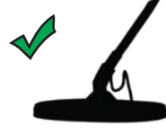
Richtiger Winkel der Suchspule zum Boden
