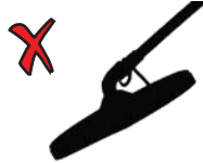
Falscher Winkel der Suchspule zum Boden
